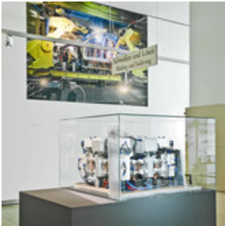
CO2-Laserresonator für Laserbearbeitungsmaschinen in der Industrie
