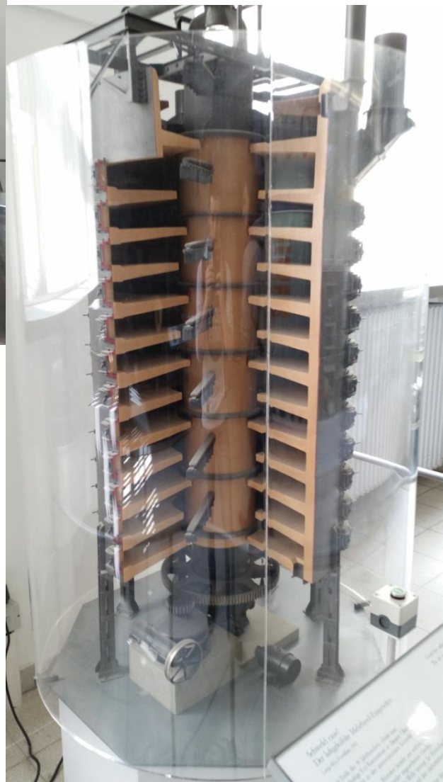
Modell eines Mehrherd-Etagenofen zur Entfernung unerwünschten Schwefels aus Kupferhaltigem Erz-Konzentrat.
