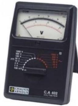
Le voltmètre, branché en parallèle, mesure ici la tension  $U_L$  aux bornes de la lampe.
