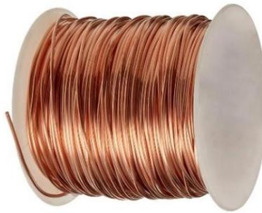
Rappelons que dans les corps solides, seulement les électrons sont susceptibles de se déplacer. Les protons sont confinés dans le noyau atomique et les atomes eux-mêmes ont une position fixe dans la structure microscopique du corps. Par conséquent, les corps solides sont conducteurs sous condition qu'ils renferment des **électrons libres**, c'est-à-dire des électrons peu liés aux noyaux et capables de se déplacer d'un atome à l'autre. Ceci est le cas notamment pour les métaux.
