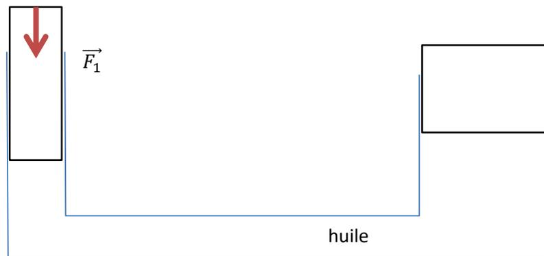
Mesurer  $F_1$ , les diamètres  $d_1$  et  $d_2$  et calculer les sections  $S_1$  et  $S_2$  des deux pistons.
