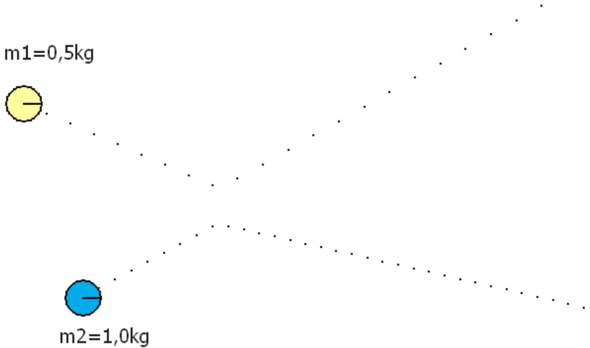
Le choc élastique entre deux disques sur la table à coussin d'air donne l'enregistrement suivant. L'écart entre deux points vaut  $\tau = 0,1\text{s}$ . Calculer les vecteurs vitesse et quantité de mouvement avant et après le choc. Constatation :  $\vec{p}_i = \vec{p}_f$  resp  $\begin{cases} m_1 v_{1x} + m_2 v_{2x} = m_1 v'_{1x} + m_2 v'_{2x} \\ m_1 v_{1y} + m_2 v_{2y} = m_1 v'_{1y} + m_2 v'_{2y} \end{cases}$
