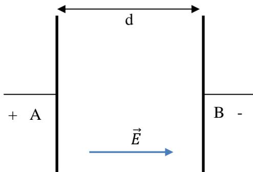
On applique une tension positive  $U=U_{AB}$  entre les plaques d'un condensateur.
