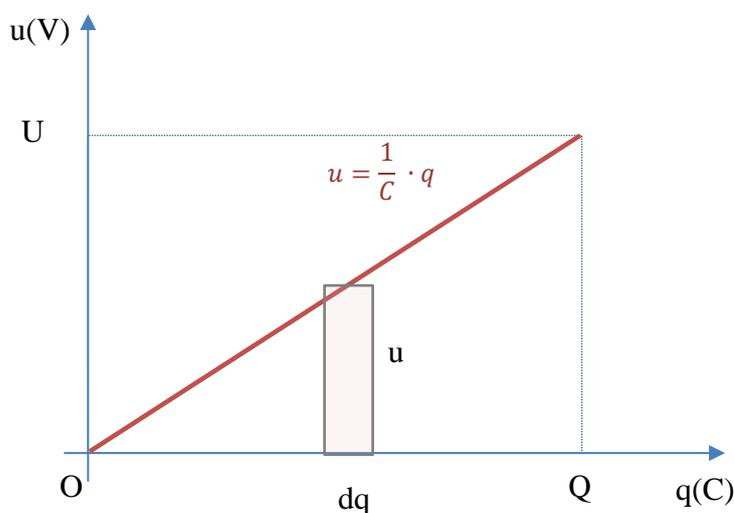
Le travail électrique élémentaire à fournir pour augmenter la charge de  $q$  vers  $q+dq$  vaut  $dW = dq \cdot u$  ce qui équivaut sur la figure à l'aire du rectangle indiqué
