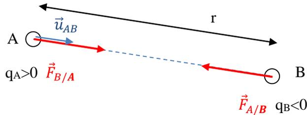
Coulomb établit expérimentalement (1784) que la force électrostatique entre ces 2 charges est:
