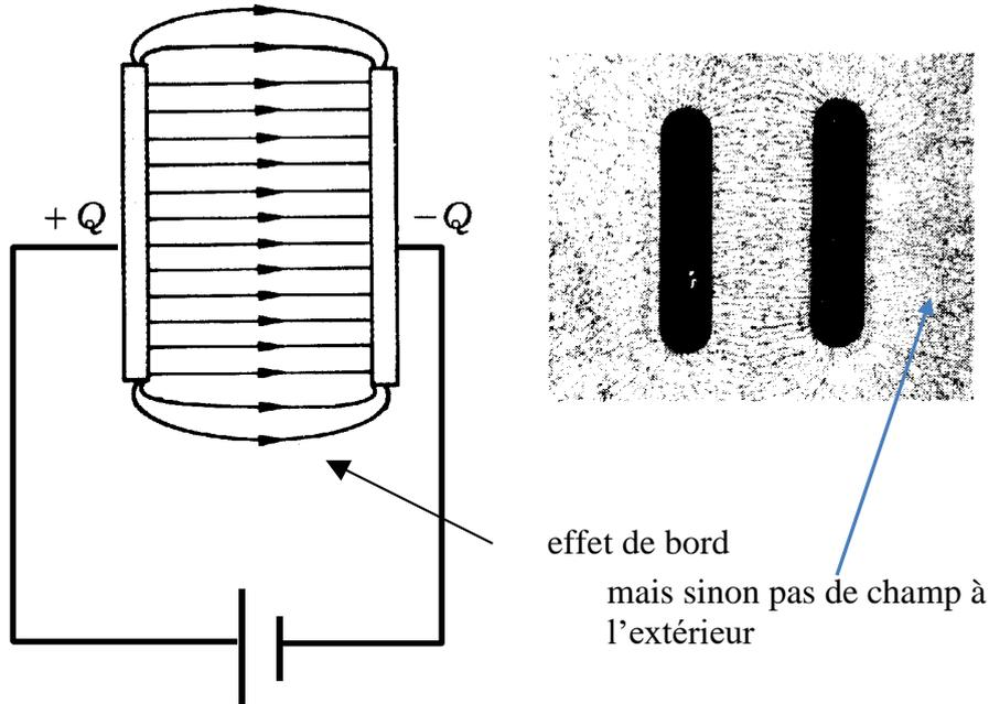
**d. Champ électrostatique entre deux électrodes de forme quelconque**
