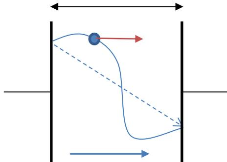
La charge test  $q$  part de la plaque A et sera attirée vers la plaque B. On veut calculer le travail électrique  $W_{AB}$  selon un chemin quelconque.
