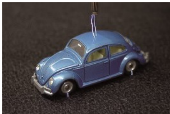
Aucun champ électrique ne règne à l'intérieur du cylindre creux et conducteur. La carrosserie d'une voiture constitue une cage de Faraday.
