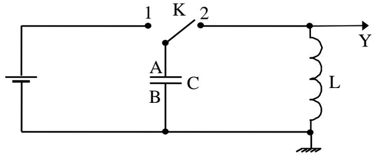
On étudie l'évolution, au cours du temps, de la tension instantanée  $u_{AB} = u$  que l'on observe sur la voie Y de l'oscilloscope.
