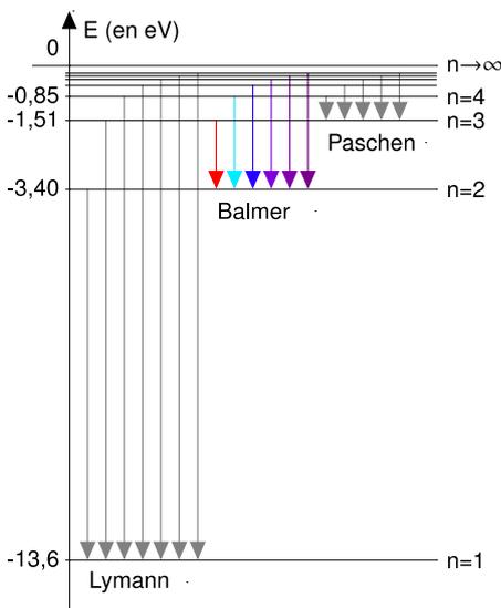
figure 3 : Niveaux d'énergie de l'atome d'hydrogène
