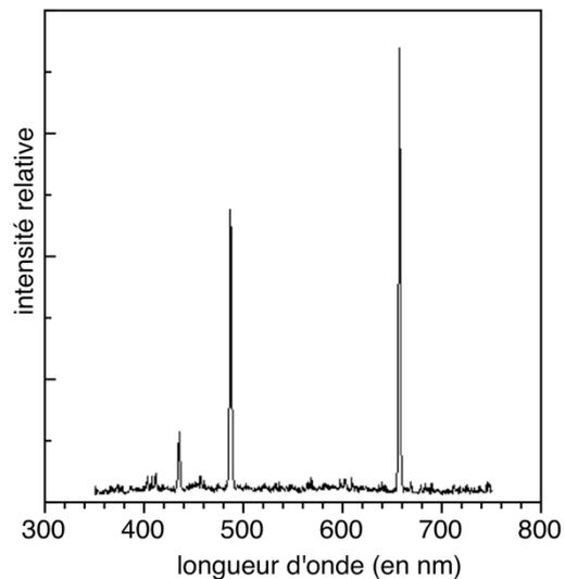
figure 4 : Mesure du spectre visible (série Balmer) de l'atome d'hydrogène
