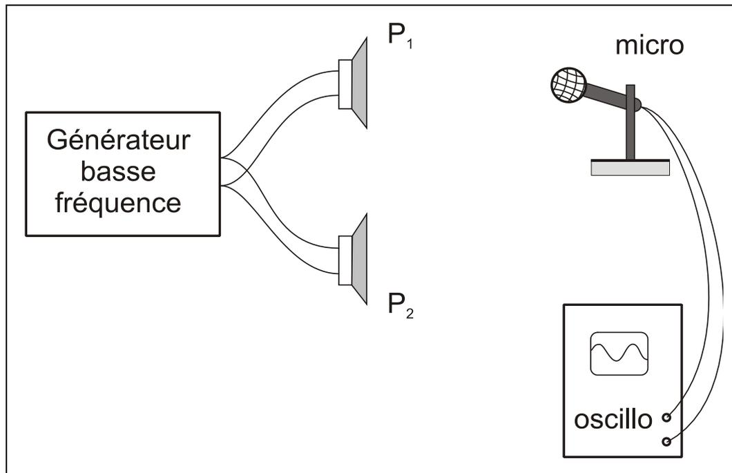
L'amplitude dépend de la position M du microphone. Si on déplace le microphone p.ex. entre les 2 haut-parleurs (ou n'importe où dans l'espace) on détecte alternativement des minimums et des maximums de vibrations.
