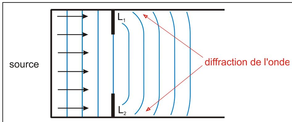
Les ondes se propagent dans la seconde partie de la cuve sans perturbation importante. Aux bords cependant, on observe la diffraction des ondes.
