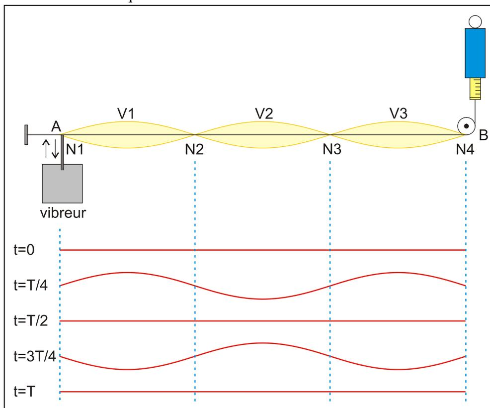
Pour une fréquence  $f$  convenable, on voit un nombre entier de fuseaux de longueur  $\lambda/2$ . Ces fuseaux ne semblent pas se déplacer, on parle de formation **d'ondes stationnaires**.
