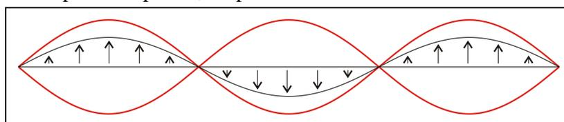
Vu de loin, le système paraît immobile; il n'y a pas de progression le long de la corde: le phénomène est appelé **onde stationnaire**. L'éclairage stroboscopique permet de voir que la corde se déforme sur place. Deux fuseaux voisins vibrent en opposition de phase.
