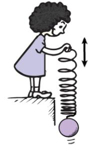
L'étude expérimentale d'un tel système, réalisé avec un excitateur qui crée un mouvement d'amplitude constante et de fréquence variable, permet de faire les observations suivantes :
