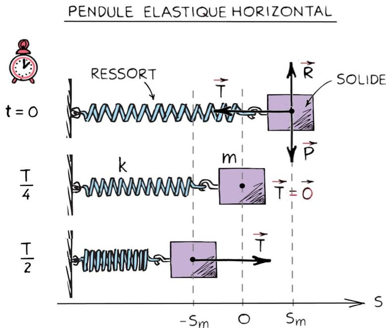
La tension du ressort est la seule force ayant une coordonnée tangentielle non nulle. C'est la force de rappel de l'oscillateur élastique horizontal. D'après la loi de Hooke elle s'écrit :
